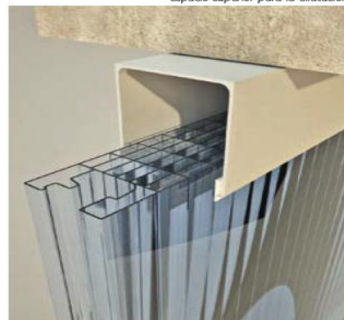
PERFIL SUPERIOR Detalle de cerramiento vertical y espacio superior para la dilatación.
